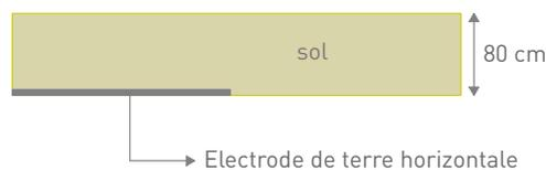
**Composition** L'électrode de terre horizontale se compose d'un conducteur en cuivre massif de forme circulaire, éventuellement gainé de plomb. Le diamètre du conducteur est d'au moins 35 mm<sup>2</sup>.
