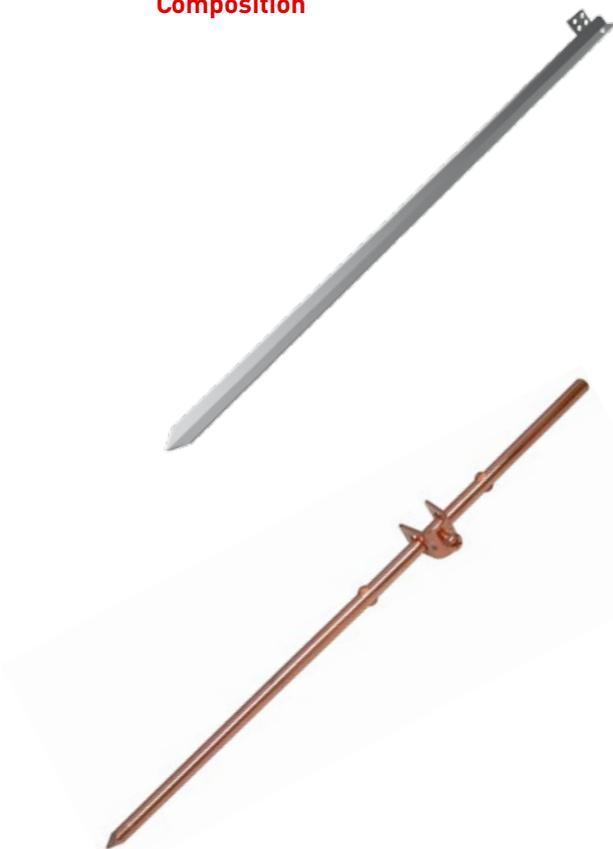
**Le piquet de terre** peut se composer d'acier galvanisé ou d'un alliage de cuivre. Lorsqu'on utilise un piquet de terre en acier galvanisé, l'épaisseur de l'aile et de l'âme doit être d'au moins 4 millimètres. Avec un piquet de terre en alliage cuivreux, l'épaisseur de l'aile et de l'âme doit être d'au moins 3 millimètres. Dans les deux cas, la longueur minimale du piquet est de 1,5 mètre.
