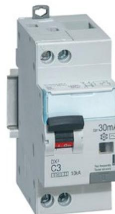
**Installation** L'interrupteur différentiel se place à l'origine de l'installation (interrupteur différentiel principal de 300 mA) ou du circuit (interrupteur différentiel complémentaire pour locaux humides de 30 mA).
