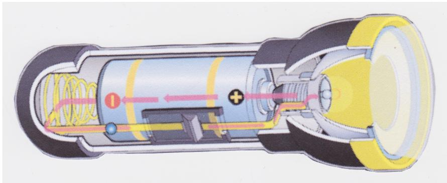
Le circuit électrique d'une lampe de poche forme une boucle qui relie l'....., la (les) ..... et l'..... entre eux.
