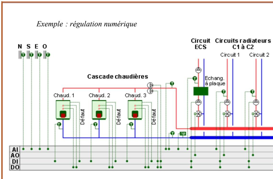
fonctionnement si l'irrigation n'est pas suffisante. Un pressostat manque d'eau vérifiera la présence suffisante d'eau dans l'installation et sera placé sur le collecteur primaire général. Ces points seront contrôlés par la régulation DDC, de même qu'un défaut de fonctionnement brûleur par chaudière. La pompe primaire est une pompe jumelée qui sera commandée par la régulation DDC qui en assurera également la permutation automatique.
