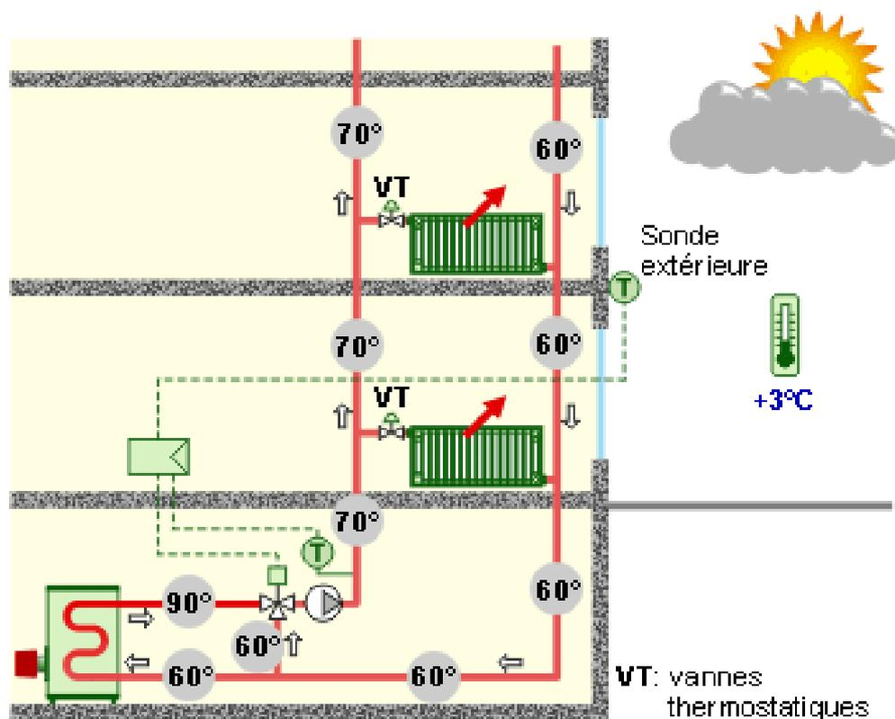
La température d'alimentation est donc identique pour tous les radiateurs du circuit. Or les besoins de chaque pièce sont différents ... Que faire ? en plaçant des vannes thermostatiques sur chaque radiateur, on va adapter le débit d'eau chaude cette fois, en fonction des besoins.
