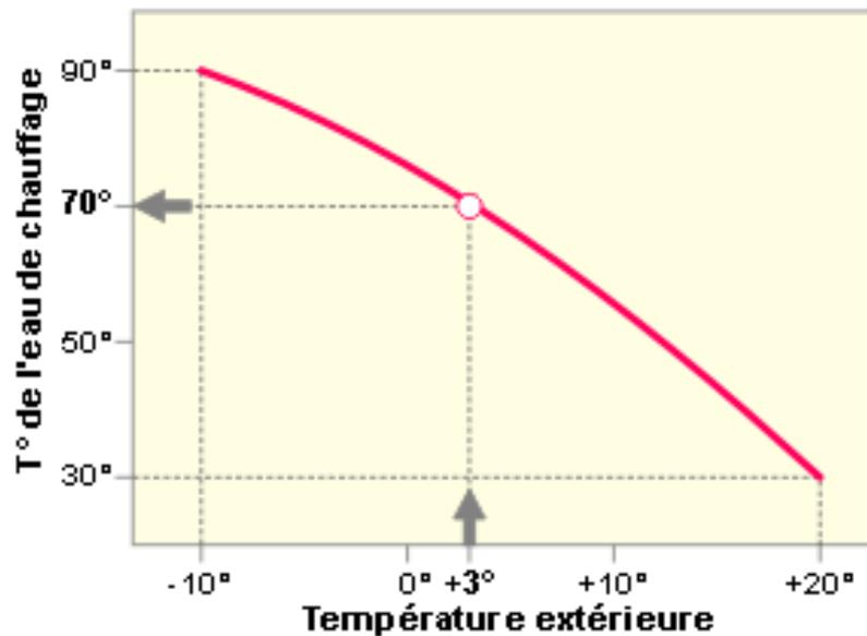
Si la température extérieure est de 3°C, on demandera au circuit une alimentation par de l'eau à 70°C.
