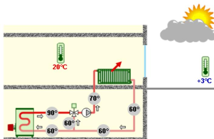
Pour alimenter le radiateur avec de l'eau à température "mitigée" ( $70^{\circ}$ ), on réalise un mélange entre l'eau chaude qui arrive de la chaudière ( $90^{\circ}$ ) et l'eau tiède qui sort du radiateur ( $60^{\circ}$ ).
