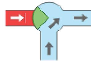
La vanne est fermée ; l'eau des radiateurs tourne sur elle-même et se refroidit.
