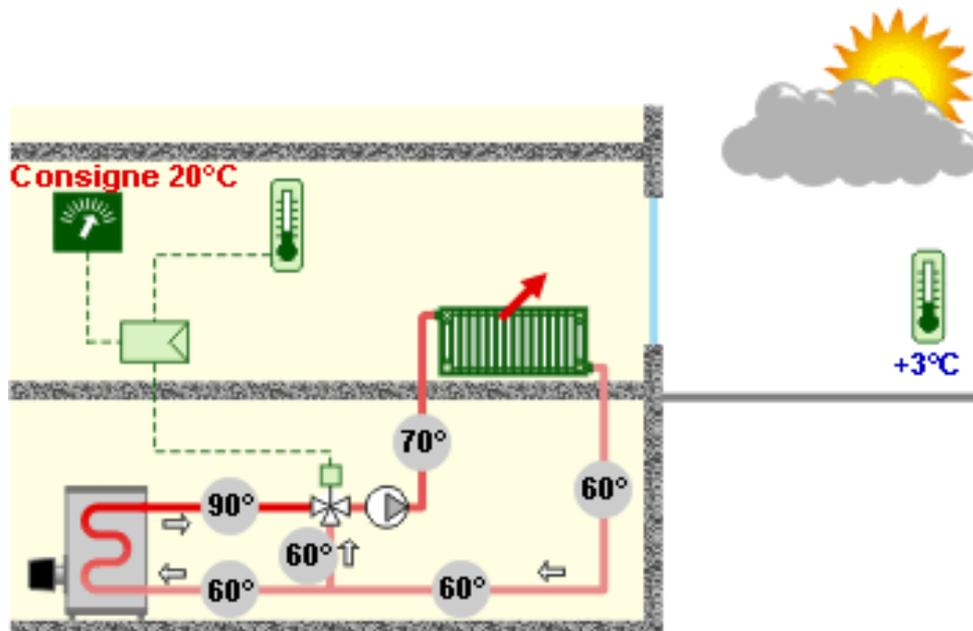
Un régulateur va relever la température existante dans le local, va comparer celle-ci à la température de consigne, et en fonction de l'écart existant, ouvrira ou fermera la vanne trois voies mélangeuse.
