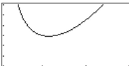
Presser **F1** (Trace) et déplacer grâce à ▲ et ▾ le curseur en forme de « + » le long du tracé jusqu'au point le plus bas de la courbe. Les coordonnées du point cible sont affichées au bas de l'écran et permettent de se faire une première idée de la valeur cherchée de X (entre 1.02 et 1.32)
