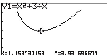
Un zoom va nous permettre d'affiner la recherche. Presser **F2** (ZOOM) puis **F1** (BOX). Le mode BOX permet de définir, autour du point cherché, un rectangle qui déterminera les limites de la nouvelle fenêtre de visualisation.
