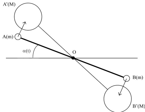
Figure 2.7 – Le pendule de torsion
