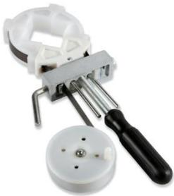
**La presse à cadre** ; C'est un outil permettant d'assembler et de coller un cadre facilement, le serrage se fait par traction sur les angles. Elle peut être à sangle, à corde ou à collier de cerclage.
