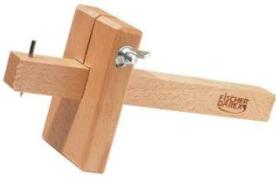
**Le trusquin** ; Le trusquin permet de réaliser un tracé par gravage de lignes parallèles à une surface d'appui. (Exemple d'utilisation : le tracé des tenons et mortaises).
