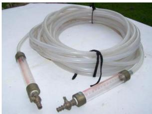
**Le niveau à eau** ; C'est un instrument ancestral et rudimentaire, il repose sur le principe des vases communicants.
