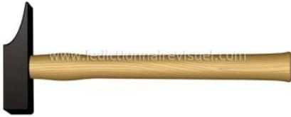
**Le marteau de menuisier** ; C'est un outil percuteur, servant par exemple à enfoncer un clou. Le marteau est fait d'une tête et d'un manche. La tête est constituée d'une masse métallique, elle agit par inertie, augmentée par la longueur du manche et celle du bras du manipulateur. Un bon marteau est conçu pour que la prise en main corresponde au centre de percussion.
