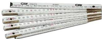
**Le mètre pliant** ; Il sert à relever et à reporter des mesures, il mesure en général 2 mètres. (Appelé aussi double mètre)
