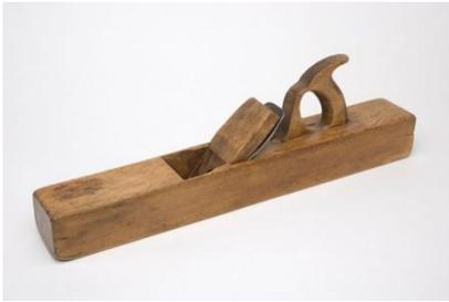
**La varlope** ; Sert à dresser de grandes surfaces. Sa longueur s'affranchit des creux et des bosses de la pièce de bois à dresser. Sur les modèles sans réglages fins de sortie du fer on bloque la lame avec un coin en bois bien ajusté et on tape avec un maillet léger sur le nez pour donner de la lame ou bien on tape l'arrière pour en enlever.
