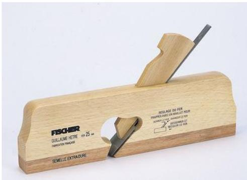
**Le guillaume** ; Il sert à réaliser des feuillures, il est souvent muni d'une butée latérale ainsi que d'un fer additionnel: "le grain d'orge" permettant une coupe latérale. Il permet aussi de retoucher les épaulements de tenons.
