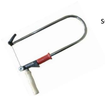
**La scie à chantourner** ; C'est une scie à poignée pourvue d'une fine lame souple tenue par une monture de métal rigide en forme de U. La scie à chantourner est principalement utilisée pour découper des fines pièces de bois.
