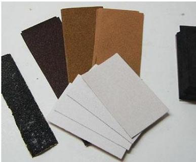
**Le papier abrasif** : C'est un papier à la surface duquel est fixé un matériel abrasif. Il est utilisé pour polir la surface de divers matériaux.
