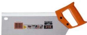
**La scie à dos** ; Scie courte dont le dessus est renforcé par un profilé métallique ayant pour but de rigidifier l'outil lors des coupes précises. (Découpe de tenons ou de baguettes et coupes d'onglet).
