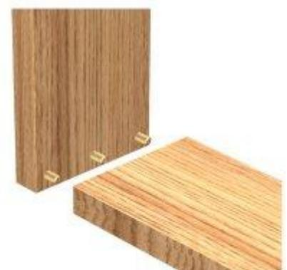
On peut les disposer en quinconce sur des surfaces importantes. Cet assemblage facile à réaliser convient parfaitement pour réunir les pièces découpées. Les tourillons engagés et collés assez profondément ont l'avantage de consolider les bois « tranchés » affaiblis par le sectionnement oblique des fibres occasionné par le découpage.
