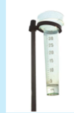
Le pluviomètre mesure la quantité de pluie tombée.
