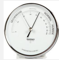
L'hygromètre mesure l'humidité de l'air.
